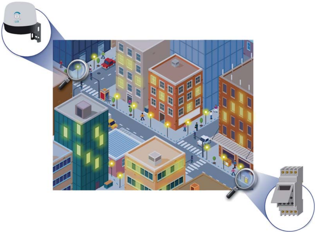
Figura 3.8. Ejemplo de instalación eléctrica de infraestructuras con interruptor horario astronómico e interruptor crepuscular
