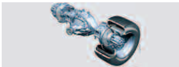
Puente de reducción
